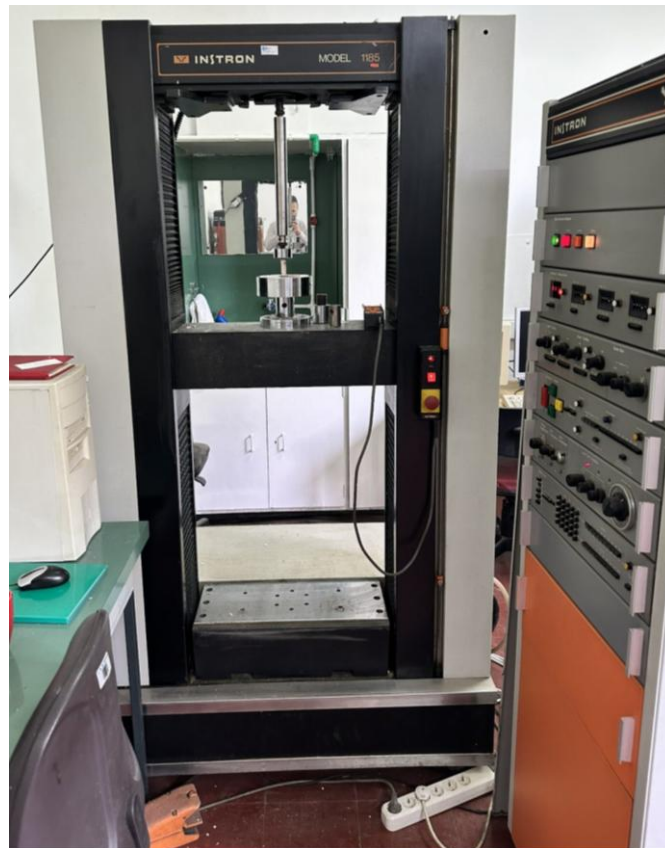
Слика 6. На слици је приказан апарат Instron 1185 за тестирање механичких особина материјала. На овом апарату вршена је процена сила за савојну и компресиону чврстоћу.
